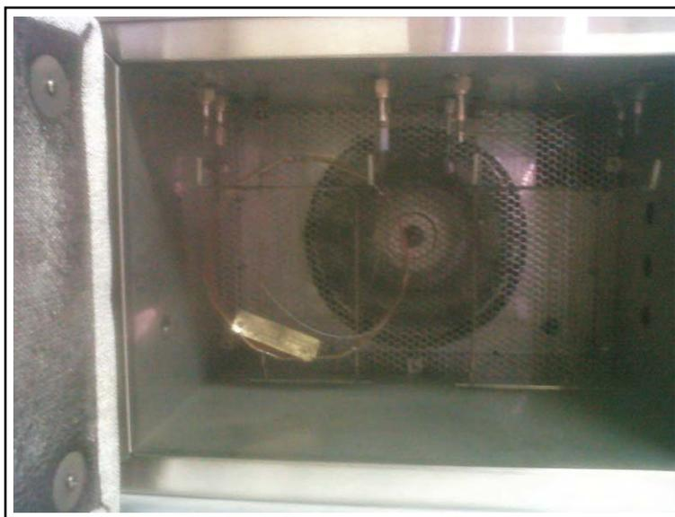
**Figura 3.2.** Columna DB-1 y Horno de la Columna.
